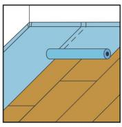
5. Vérifier la nécessité de poser un régulateur ou une barrière de vapeur
