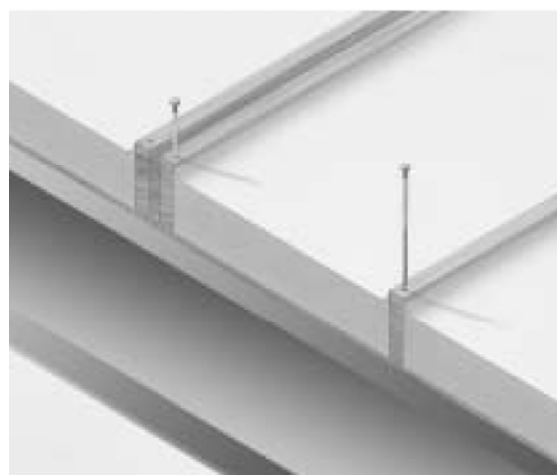
Figure 3 – fixation sur charpente métallique
