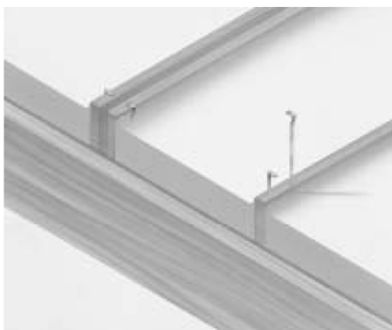
Figure 2 – fixation sur charpente bois
