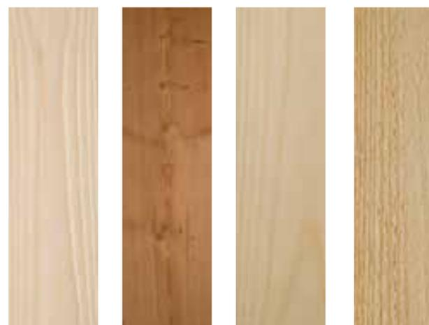
Brossé structuré Thermochauffé Brossé structuré Raboté Brut de sciage
