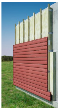
Mise en place d'un pare-pluie
