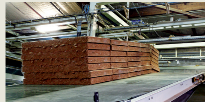
Cours-la-Ville (69) – Unité de fabrication d'isolants semi-rigides, dits "Flex"
