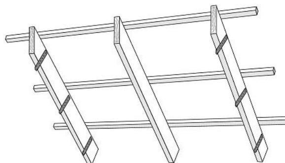
La mise en œuvre des suspentes est identique à celle décrite au paragraphe 4.4.3.1.b : leur longueur sera choisie en fonction de la hauteur de la fermette et de l'épaisseur de l'isolant de manière à ce qu'elle dépasse suffisamment de l'isolant, une fois celui-ci inséré entre les fermettes.
