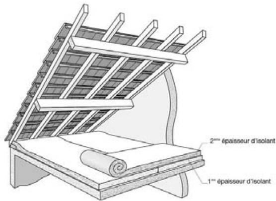
L'isolant ne doit pas obstruer les bouches de ventilation et ne doit pas être en contact avec des sources chaudes, écart au feu (conduit de cheminée, lampes,...). Pour le traitement de ces cas reportez-vous au §4.4.37.
